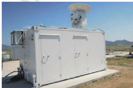
Ka-band millimeter wave cloud & fog radar
